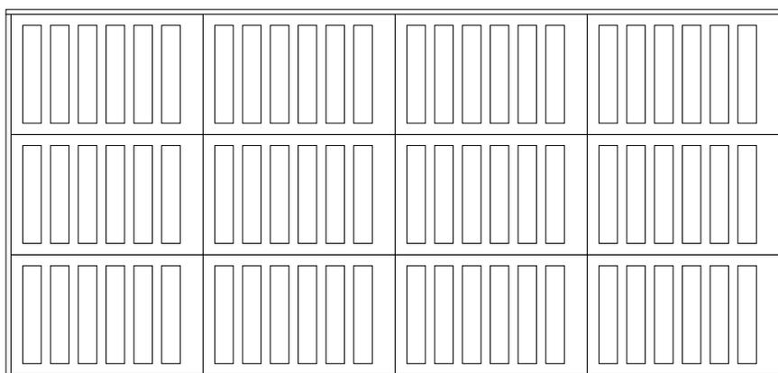
Las REJILLAS DE AIREACIÓN INCLINADAS consisten en una caja de metal con una sección oblicua, forrada internamente con material intumescente que, en caso de incendio, se expande completamente cerrando cada punto de penetración.
