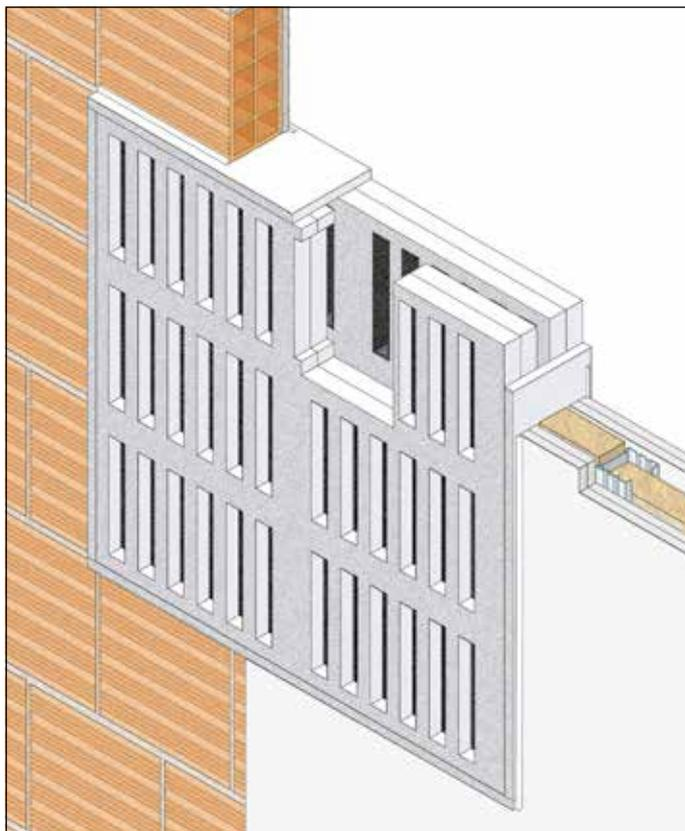
Rejilla de aeración plana compuesta por dos placas dobles de silicatos con un espesor total de 122 mm. Las placas están ranuradas y equipadas con material intumescente apropiado. La rejilla está encajonada en un marco de placa de silicato de calcio. Para muros de mampostería o cartón yeso con un grueso mínimo de 100 mm.
