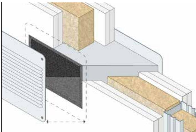
Rejilla de aireación inclinada a 45 ° constituida por una caja de metal con sección oblicua, forrada internamente con material intumescente que en caso de incendio se expande cerrando completamente cada punto de penetración.
