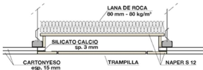
*Nota:* La trampilla debe estar protegida en la parte superior por una tapa (incluida en el paquete); La tapa debe estar protegida con un panel aislante de lana de roca de 80 mm de grosor, densidad 80 kg/m<sup>2</sup>.
