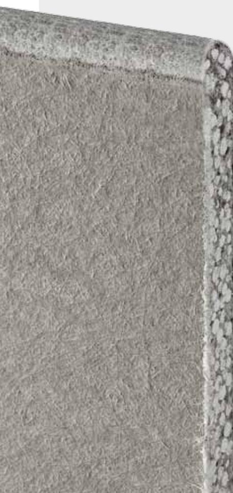
UNIFLEX es la placa de cemento reforzado, de 12,5 mm de espesor, la más flexible existente en el mercado, capaz de alcanzar un radio de curvatura de 150 mm (para ángulos de 90°) sin roturas o grietas y sobre todo sin deformarse.
